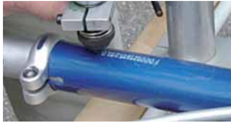
Kennzeichnung mit EIN-Code durch klassische Gravur. Ein transparenter Aufkleber schützt anschließend gegen Korrosion. Quelle: ADFC Fachausschuss Technik
