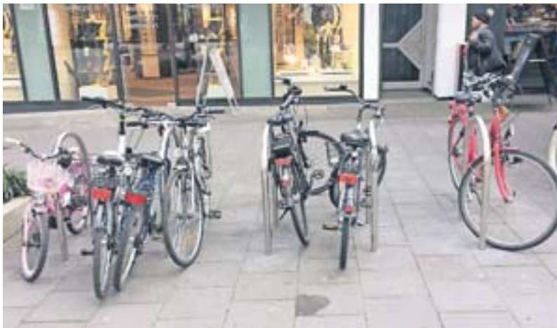
Die Bügel sind zu eng, um zwei Räder problemlos anzuschließen.
